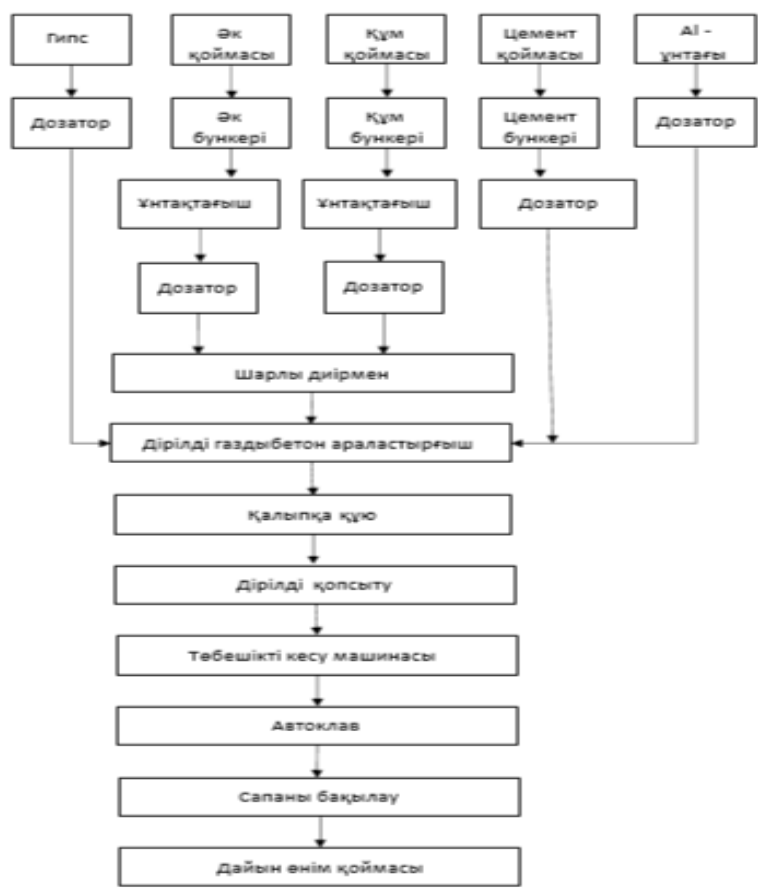
Сурет 1.2 - Ұялы бетон өндірудің технологиялық схемасы
